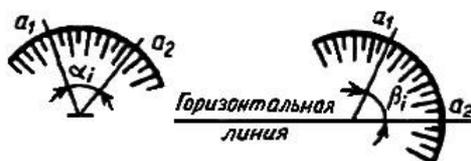
$\alpha_i, \beta_i$  - горизонтальные и вертикальные углы, соответственно, измеряются и вычисляются по методикам и формулам, приведенным в эксплуатационной документации на данный тип угломерного прибора
